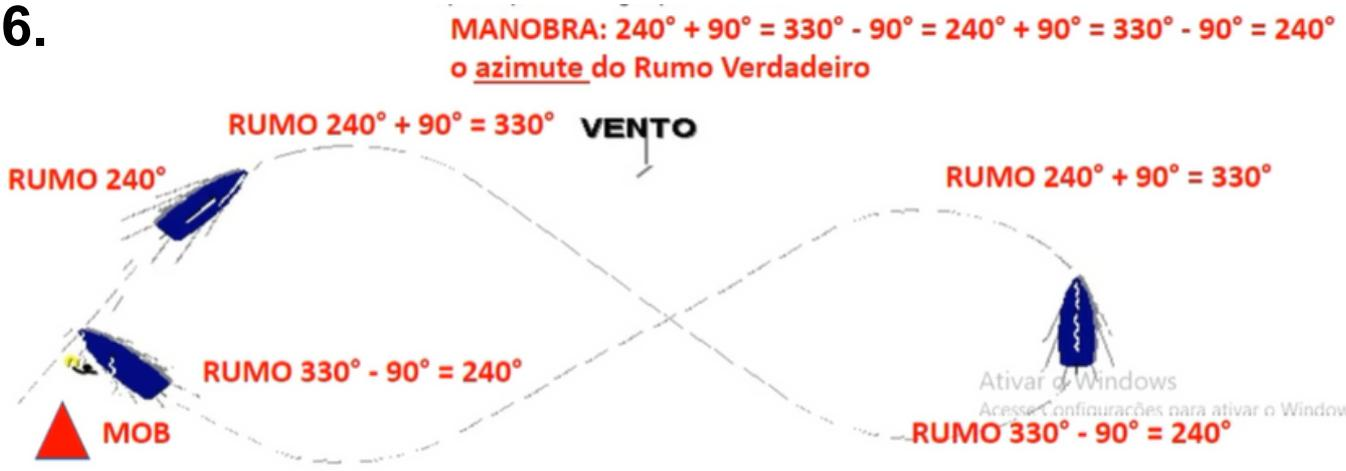
MANOBRA:  $240^\circ + 90^\circ = 330^\circ - 90^\circ = 240^\circ + 90^\circ = 330^\circ - 90^\circ = 240^\circ$
